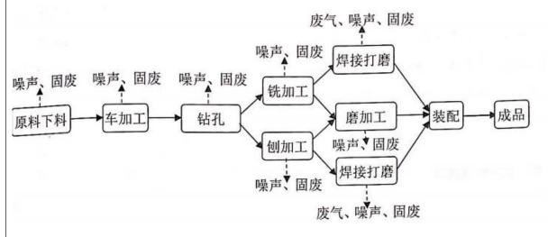
图 2-1 生产工艺流程及产污节点图
