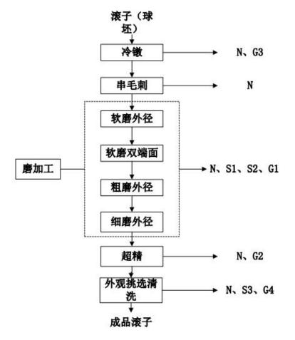
图 2-3 滚子生产工艺流程及产污节点图
