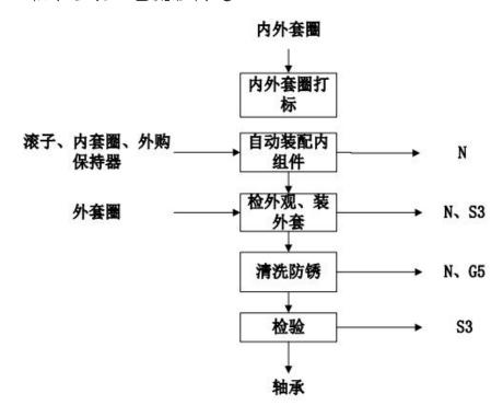
图 2-4 轴承组装生产工艺流程及产污节点图
