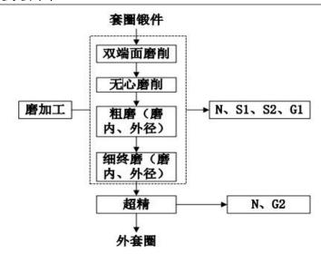
图 2-1 外套圈生产工艺流程及产污节点图
