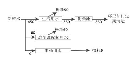
图 2-2 该项目水平衡示意图 (m³/a)
