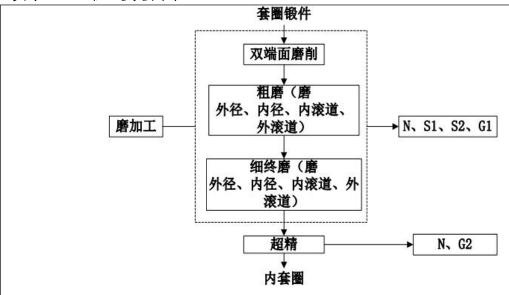
图 2-2 内套圈生产工艺流程及产污节点图
